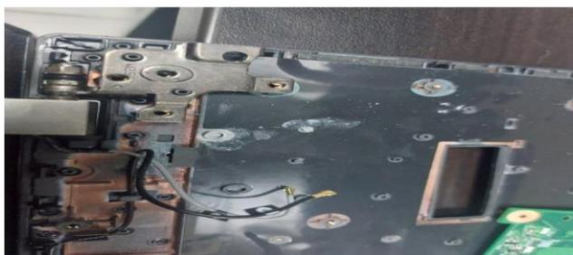
2.2. Como se muestran en las imágenes adjuntas en el presente informe se verifica que el equipo se encuentra en mal estado por lo que no solo la solución sería un cambio de Mainboard, sino otros componentes puedan estar comprometidos en el derramamiento de líquido que ocasiono este problema.
